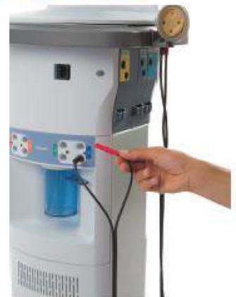
Vežimėlis su įrengtu vakuumo moduliu
